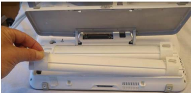
Figura 3-6. Înlocuirea unei baterii
